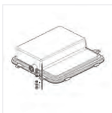
BASE: 4 ranuras para montaje en tirante
