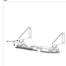
COMBI y MODULE: montaje mural basculante regulable
