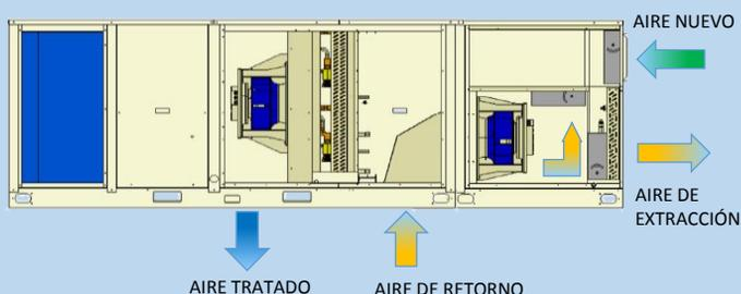
Gracias a la alta capacidad de sus ventiladores, esos equipos pueden incorporar filtros de alta eficiencia, incluso de clase H13 o superior, con una eficacia MPPS del 99,95%.
