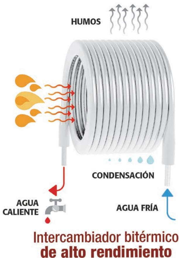
La Integración en un solo bloque, tanto del intercambiador sanitario como del primario, reduce las temperaturas medias del ejercicio, en particular durante la producción de agua caliente sanitaria, favoreciendo así la condensación.
