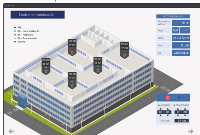
Ejemplo de control de iluminación
