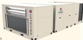
El módulo de recuperación termodinámica incorpora un circuito extra, el cual opera con un alto rendimiento frigorífico. Este circuito aprovecha el aire de extracción para recuperar parte del calor desaprovechado. Mediante la recuperación de este calor conseguimos aumentar tanto las capacidades como los rendimientos nominal y estacional del equipo.
