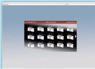
Podemos acceder a cada fancoil, para poner en on-off, modificar setpoint, seleccionar velocidad automática o manual baja, media o alta y ver estado frío o calor.
