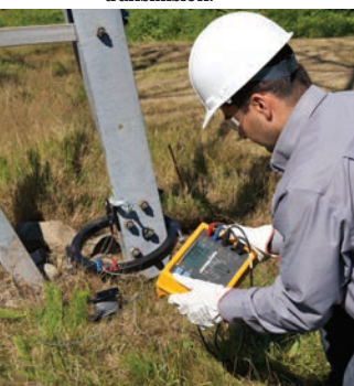
Transformador tipo pinza para medidas de lazo de tierra en torres de transmisión.
