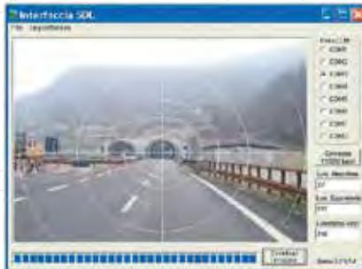
El sistema CL20 está formado por dos sensores que miden la luminancia de velo o L20 en la boca del túnel a la distancia de parada y un sistema de control y gestión de los dispositivos de alumbrado.
