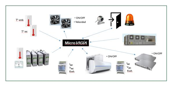
El MicroVigía se integra dentro de la infraestructura conectado a todos los elementos y envía los datos directamente al servidor web. A través de ARGOS, el monitor web de Desigenia, podemos recopilar y analizar una gran cantidad de datos para prever y solucionar cualquier incidencia.
