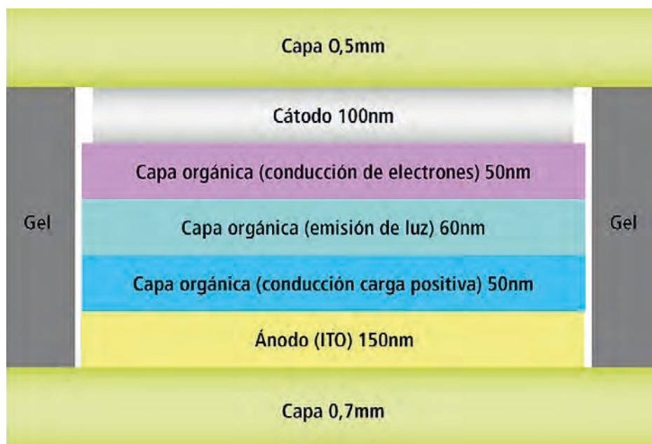
Figura 1. Composición de un OLED.
