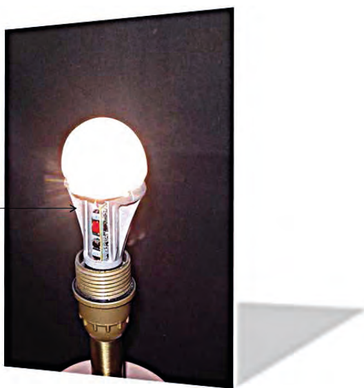
Figura 30. Disipador de calor.
