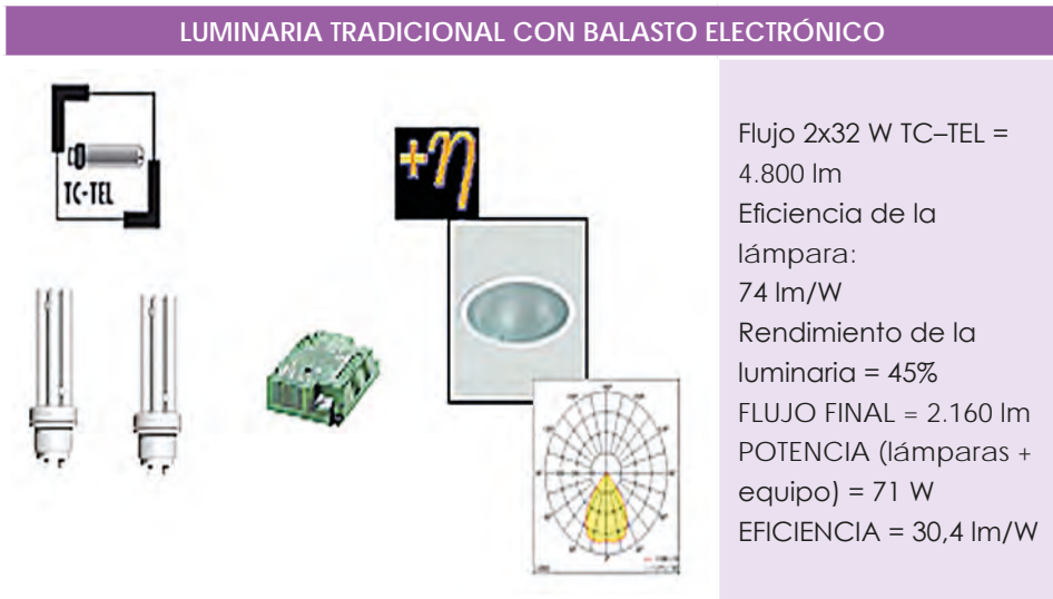
Figura 35. Características lámpara tradicional.
