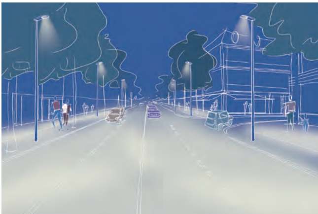
- Óptica LensoFlex2® "Carreteras urbanas" 5068 - Para clasificación M3 según CIE 115 - SR > 50% incluido
