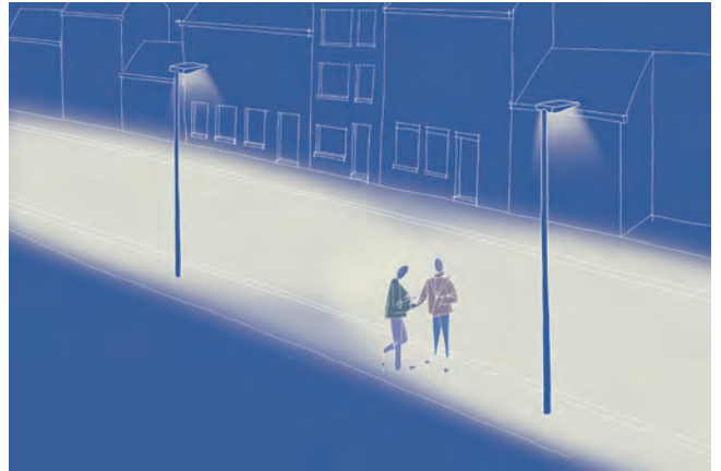
- Óptica LensoFlex2® "Calles residenciales" 5093 - Para clasificación M4 según CIE 115 - SR > 50% incluido
