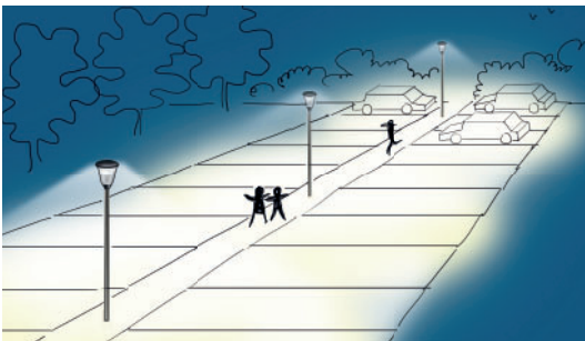
Óptica 5096 simétrica tipo plaza: únicamente disponible en 32 LED, esta distribución fotométrica ha sido concebida para la iluminación de jardines, parques, aparcamientos, plazas públicas...
