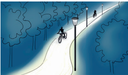
Óptica 5096 tipo vías públicas: distribución fotométrica adaptada a la iluminación de zonas residenciales, calles y paseos.
