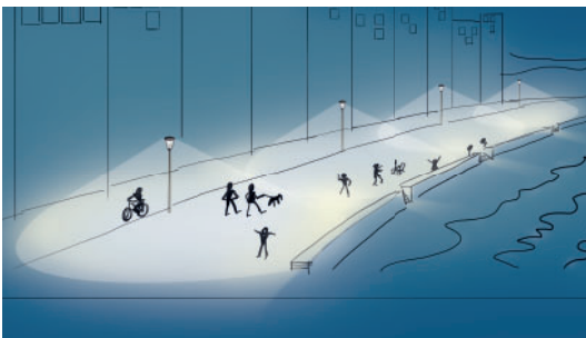
Óptica-F: distribución fotométrica polivalente adaptada a la iluminación de parques, paseos y calles estrechas.
