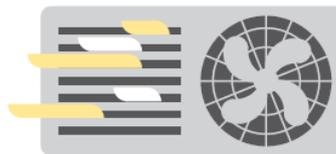
Los equipos del tipo “inverter”, que regulan la potencia por variación de la frecuencia eléctrica, ahorran energía y son más eficaces con bajas temperaturas exteriores.
